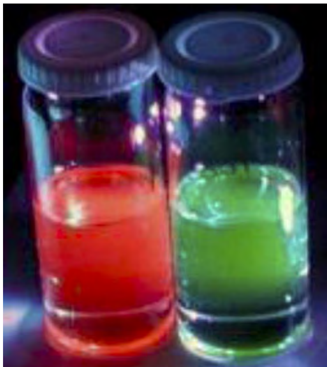
FIGURA 1. Imatge digital de QD col·loïdals de CdSe de mides diferents, preparats a l'Institut Català d'Investigació Química (ICIQ), il·luminats amb llum ultraviolada (UV). Imatge adaptada de J. ALBERO, J. N. CLIFFORD i E. PALOMARES, «Quantum dot based molecular solar cells», Coordination Chemistry Reviews , 263–264 (2014), p. 53–64. Copyright © 2014, Elsevier.
